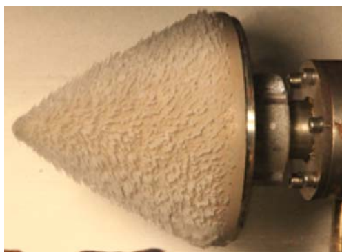
图 11 60°锥角整流罩最终冰形照片
