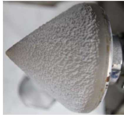
图9 74°锥角整流罩最终冰形照片
