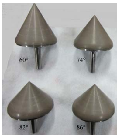
图 1 缩比整流罩实验模型
