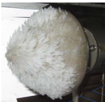
图 5 86^\circ 锥角整流罩最终冰形照片
